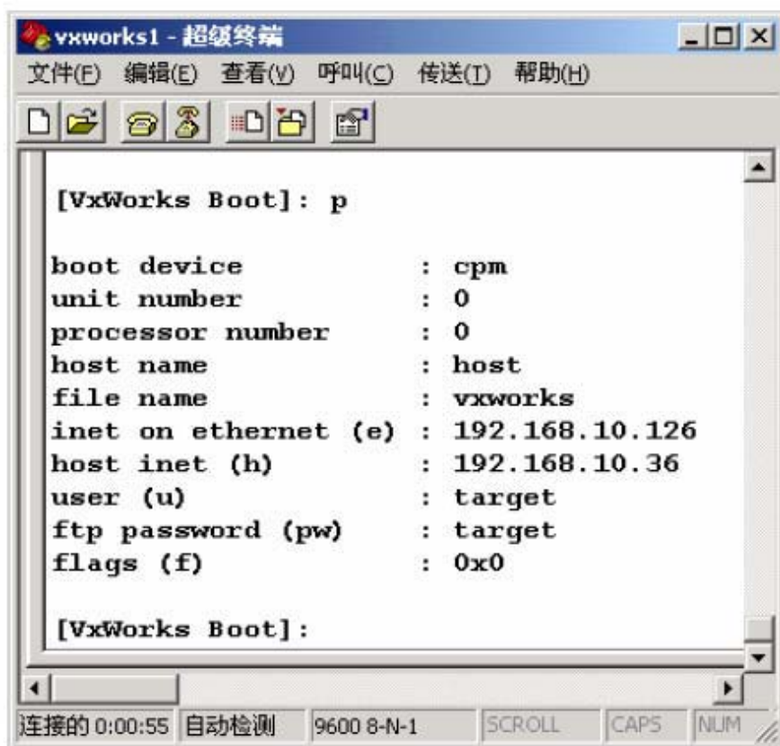
图11-1 超级终端打印出bootrom启动参数
